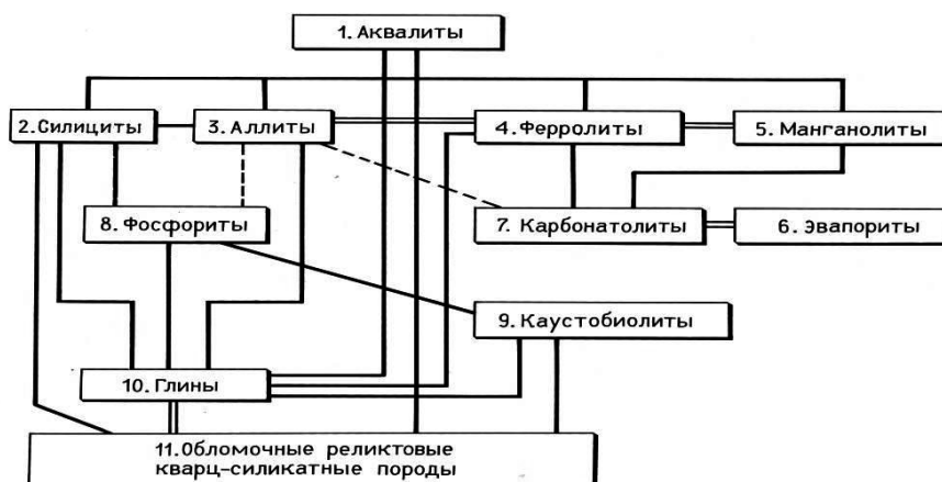
Рисунок. Классификация осадочных пород в зависимости от их структурной и генетической близости (Фролов, 1992, с. 262).
